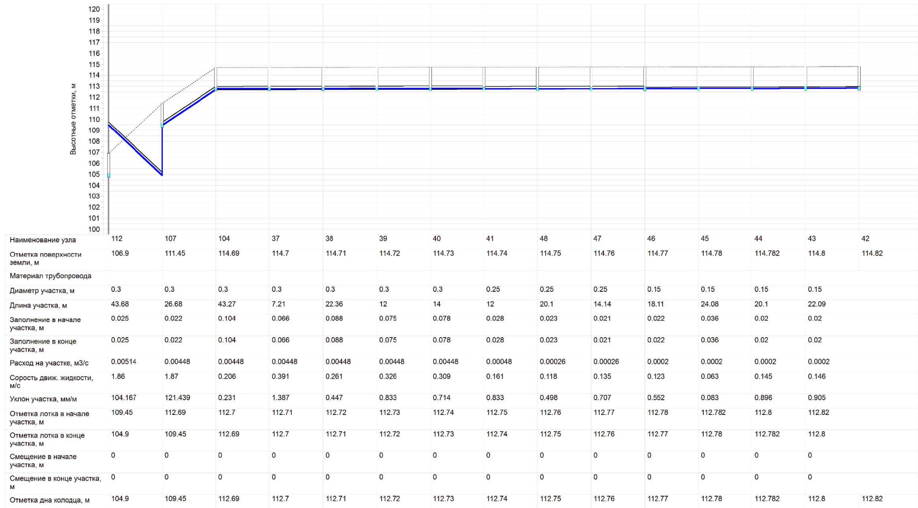
Пьезометрический график существующего участка самотечного коллектора
